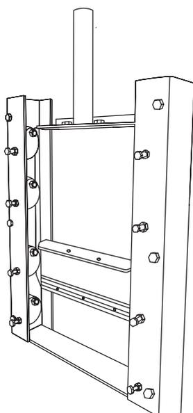
Zastawka odciekowa trój i czterostronnie szczelna posiada kształt prostokątny lub inny na żądanie.
