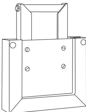
Zasuwa wsuwana posiada kształt prostokątny lub inny na żądanie.
