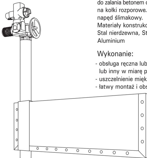
Rozdzielacze strumienia są w wykonaniu do zalania betonem oraz do zamocowania na kołki rozporowe. Posiadają własny napęd ślimakowy.
