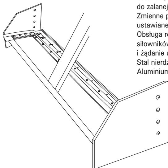
Zastawka przelewowa – wykonanie zgodne z DIN 19558 z płytą zanurzeniową w wykonaniu do zalania betonem, do zamocowania na śruby do zalanej konstrukcji mocującej. Zmienne położenie płyty przelewowej ustawiane śrubą trapezową. Obsługa ręczna lub za pomocą siłowników. Wykonanie na wymiar i żądanie użytkownika. Materiały: Stal nierdzewna, Stal węglowa, Aluminium.
