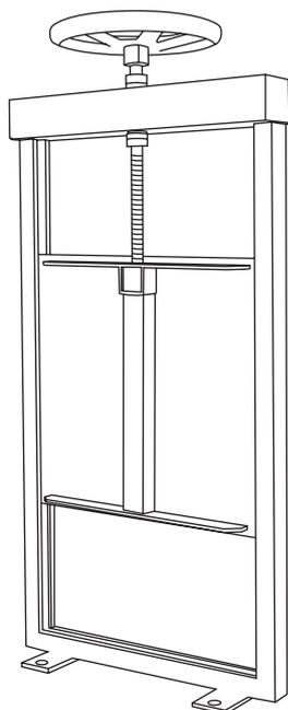
Zastawki kanałowe trój i czterostronnie szczelne mają budowę prostokątną, kwadratową oraz inną, na specjalne życzenie użytkownika
